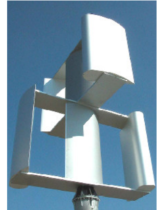
Turbina eolica ad asse verticale, produzione italiana, pot.: 9,0 KW in alluminio, diam.=3m h=6m montata su palo h=20 metri
